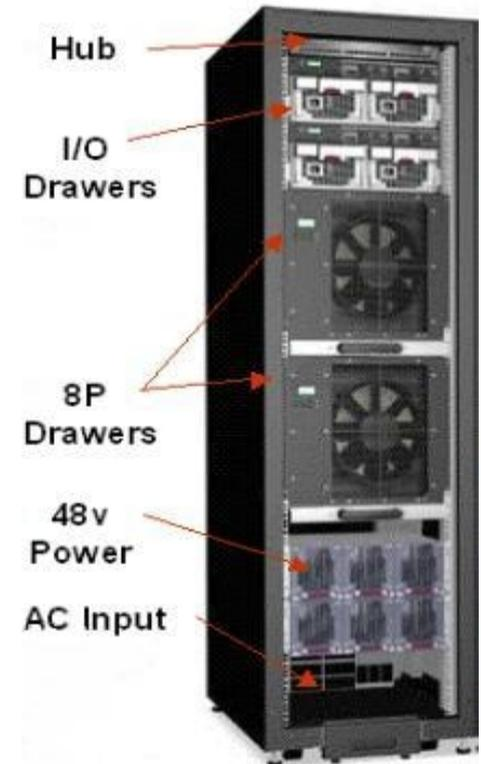
L'interconnexion des processeurs repose sur une architecture torique 2D.
